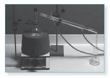
On peut aussi oxyder les alcools en utilisant les ions permanganate en milieu acide. Là encore, c'est une expérience facile à réaliser en TP, en prenant comme alcool le propan-2-ol. On utilise le dispositif suivant (voir photo ci-contre):
